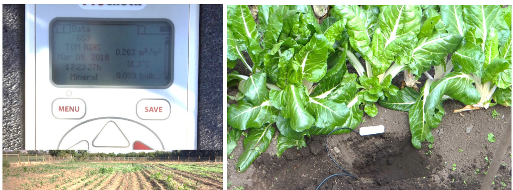
Figura 9. A la izquierda: fotografía del dato obtenido del contenido volumétrico de agua en el suelo, mediante una sonda de capacitancia y un equipo lector portátil, en un
