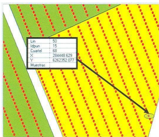
Figura 29. Incorporación de cuarteles a SIG, en donde a cada central se asocia información (en este caso información geográfica e identificación) relativa a los muestreos en cada zona.
