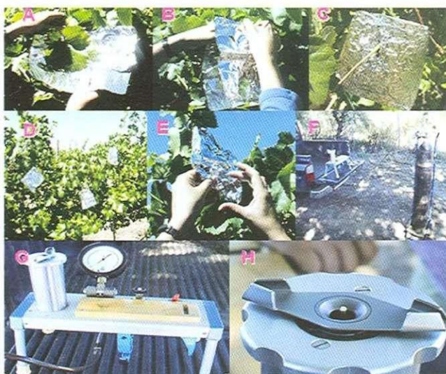
Figura 23. Medición del potencial hídrico en las hojas con Bomba Scholander; (a) selección de hojas; (b,c,d) cubrimiento de hojas con papel; (e) hoja lista para ser evaluada; (f,g) lugar e instrumento de medición, mostrado también en la Figura 14 y lectura del potencial hídrico de la hoja (h).
