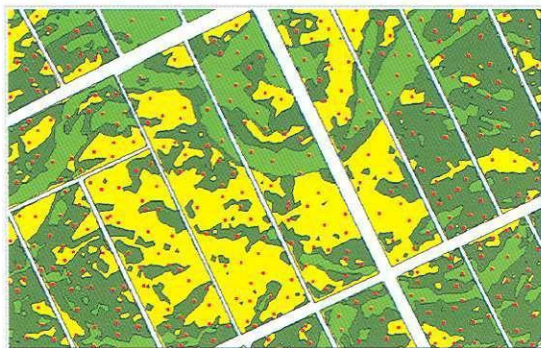
Figura 30. Plano de NDVI para los cuarteles incorporados a manejo sitio específico (con una clasificación en base a tres niveles de vigor: alto, medio y bajo), en donde se muestra puntos de muestreo (en rojo) asociados a cada zona de vigor.
