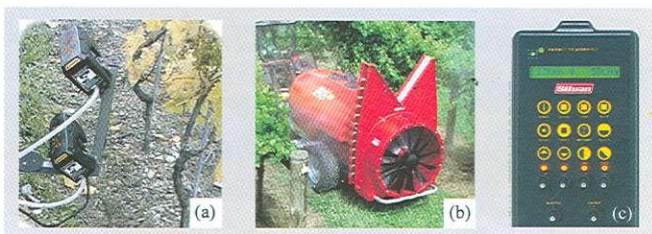
Figura 42. Aplicación diferencial de agroquímicos. (a) Herbicidas, utilizando equipo especializado para detección específica de malezas; (b) pesticidas al follaje, aplicación que es regulada en función de la cantidad de hojas haciendo uso de equipo mostrado en (c) para la programación de la aplicación. (Adaptado desde Taylor, 2004).
