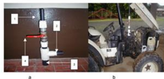
Figura 4. a) Pieza de adaptación para el uso de biogás en motor diésel b) Tractor con motor diésel con pieza incorporada
