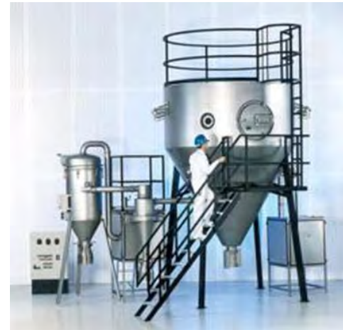
Figura 7-8: Secador spray VERSATILE-SD de escala comercial, manufacturado por GEA Niro.
