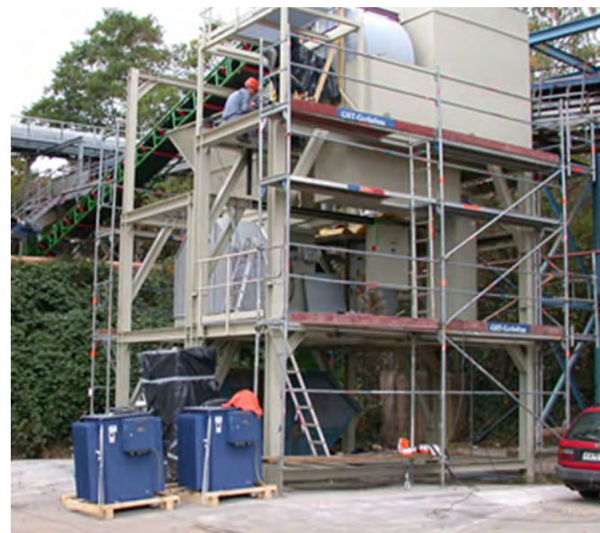
Figura 7-2: Equipo de campo eléctrico pulsado KEA-ZAR para procesamiento de remolacha, desarrollado por KIT, Alemania.
