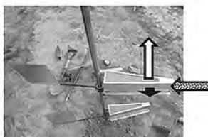
Figura 4. Salida de aire a través de malba en parte superior de bandeja y captura de partículas en parte inferior de bandeja colectora.
