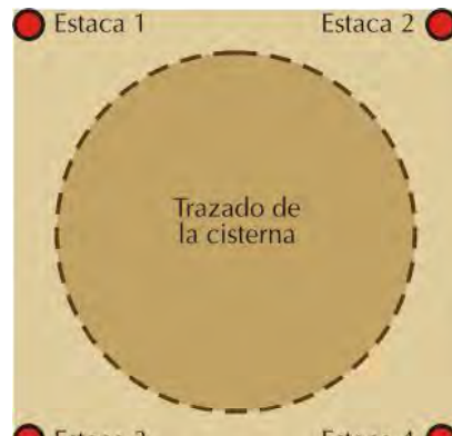
Figura 3. Esquema del trazado y la postura de estacas, para la nivelación del terreno
