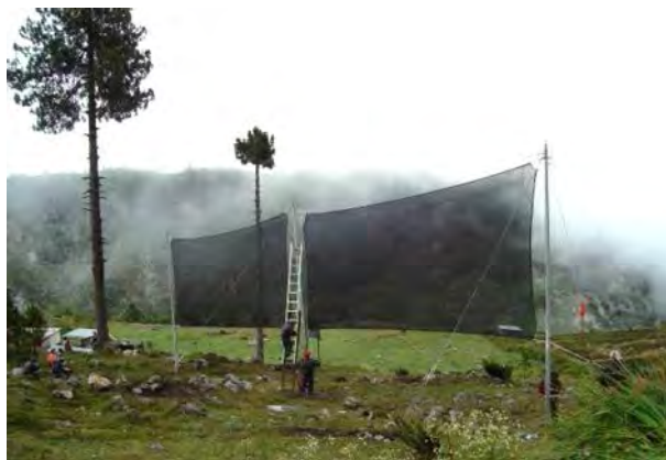
Figura 4. Estructuras “Atrapanieblas” instalados en Tojquia, Guatemala, a 3.300 m.s.n.m. (Año 2007). Proyecto FogQuest: sustainable and water solutions.
