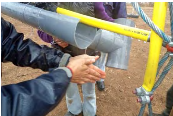
Figura 27. Evaluación del trabajo de la canaleta recogiendo agua de lluvia.
