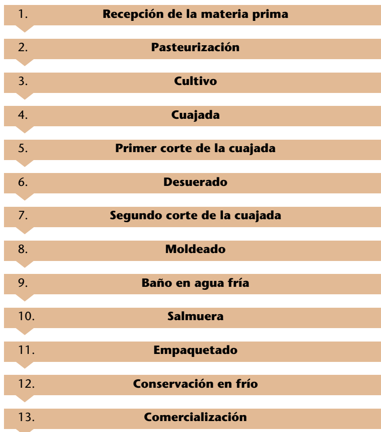
FIGURA 1. Diagrama del proceso elaboración del queso mozzarella
