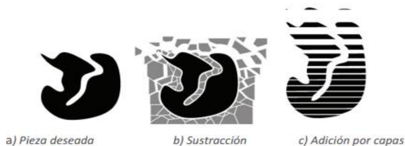
Figura 4. Concepto de fabricación aditiva comparado con la fabricación sustractiva
