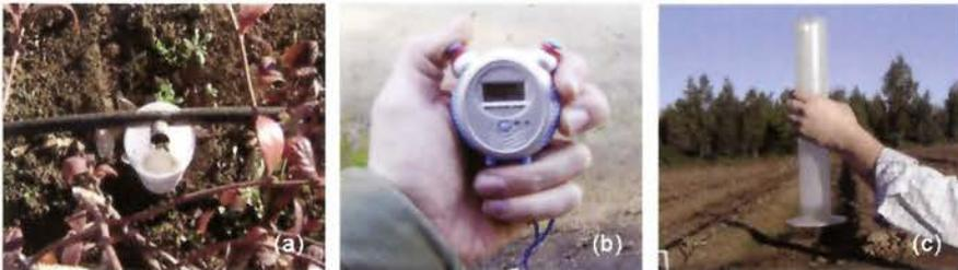
Figura 5.17. Medición de caudal por gotero, a: vaso de plumavit bajo el gotero, b: cronómetro para medir el tiempo de goteo, c: probeta para medir el volumen caído en el tiempo de goteo medido, (Antúñez, Mora y Felmer, 2010).
