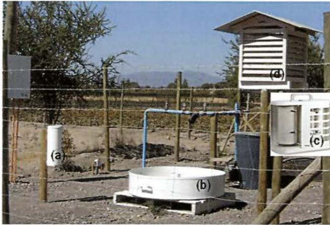
Figura 3.15. Instrumentos necesarios para llevar un registro de las condiciones ambientales en una plantación de peonías. a: pluviómetro, b: bandeja de evaporación Tipo A, c: higrómetrografo ubicado dentro de un abrigo meteorológico, definido como una estructura de medidas estandarizadas que sirve de protección al instrumento (d), (Saez, 2009).
