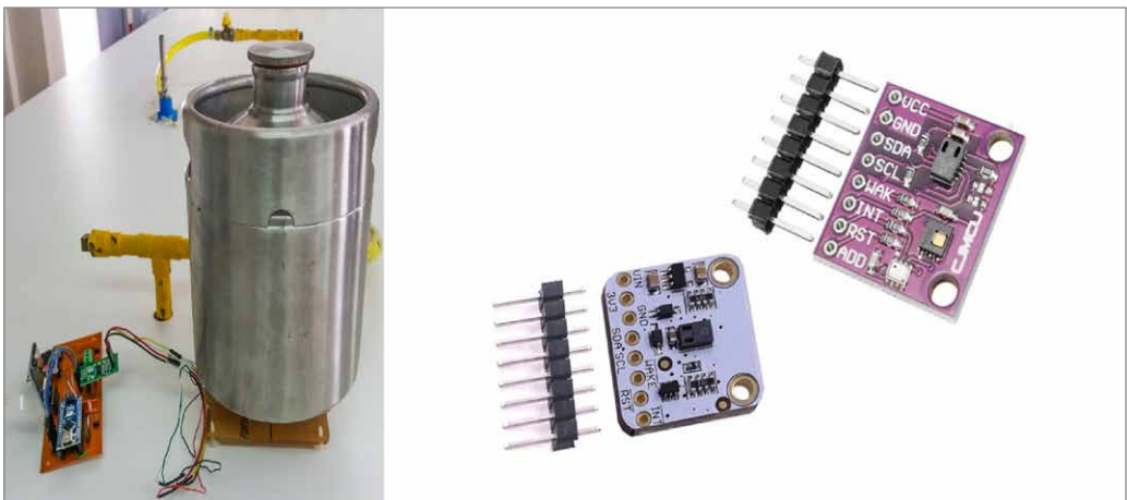
Sistema nuevo de fermentación con sensores optimizados en tamaño y tecnología para medir los parámetros más importantes: temperatura, etanol y dióxido de carbono. Fuente: proyecto precursor.
