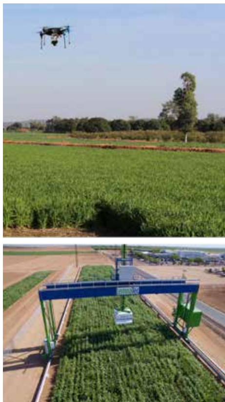
Figura 13.- Vehículo aéreo no tripulado y equipo de fenotipado automático experimental. Fuente: F. Meza 2020.
