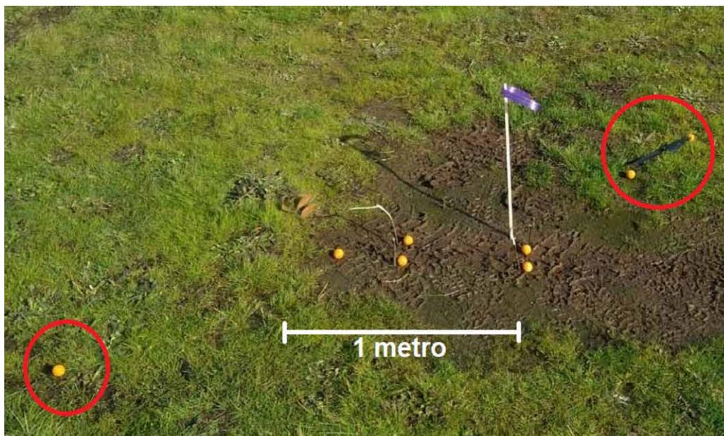
Medición de precisión de descargas. Las esferas encerradas en círculo fueron liberadas con RTK apagado, las demás con el sistema habilitado. Fuente: proyecto precursor.
