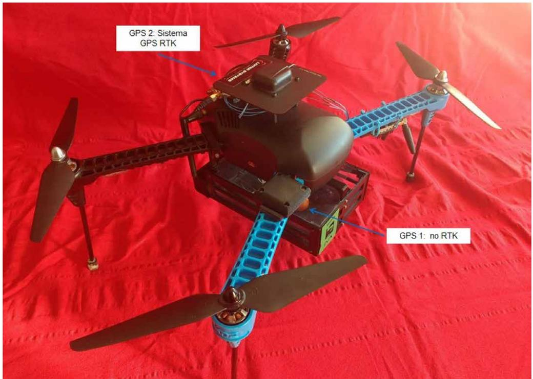
Sistema de posicionamiento del dron. Fuente: proyecto precursor.
