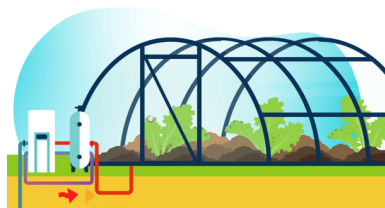
Bomba de calor geotérmica en invernadero.
