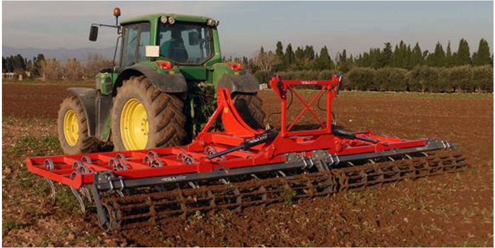
Foto 2.8. Uso de vibrocultivador para mullir suelo (Fotografía: Interempresas, 2020).
