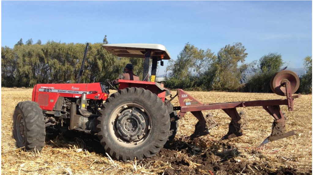
Foto 2.6. Labor de labranza primaria con arado de vertedera (Fotografía gentileza Aguirre, 2020).
