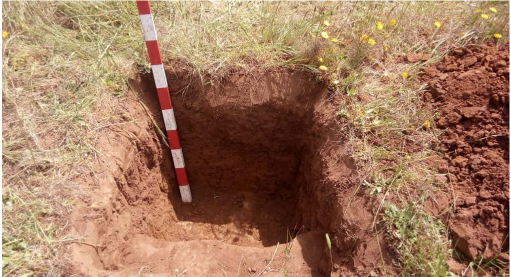
Foto 2.1. Calicata de 1 m 3 para observar perfil de suelo y extracción de muestras para determinar parámetros físicos de suelo.
