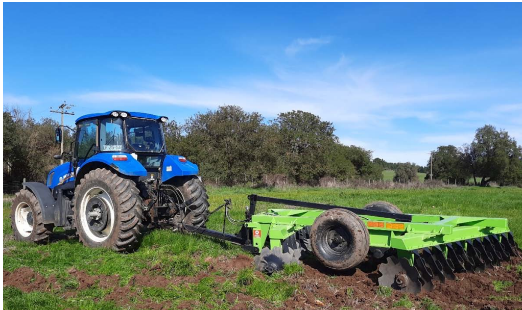
Foto 2.7. Laboreo de suelo con rastra de discos tipo off-set.
