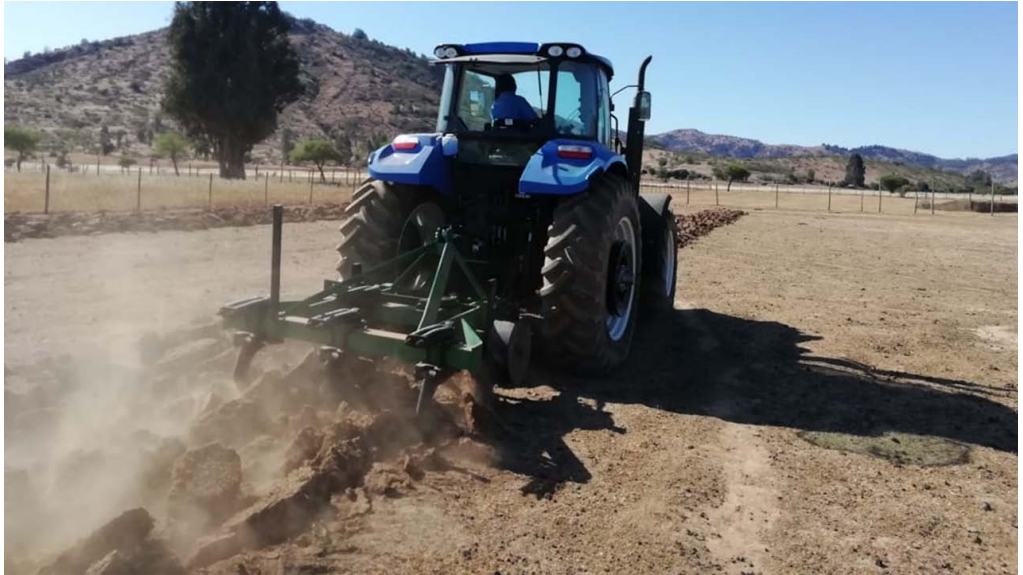
Foto 2.4. Trabajo de escarificado en suelo seco con grandes terrones en superficie (Fotografía gentileza Carrasco, 2020).
