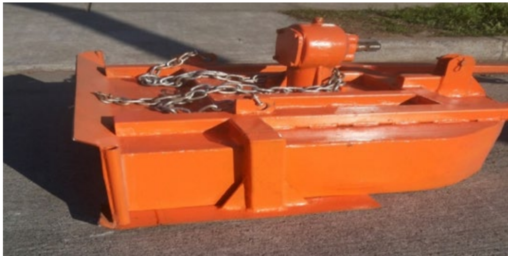
Cortadora de machos delantera rectificada, con patines incorporados y visera para el mejor ingreso de las cañas de maíz para corte. Fuente: proyecto precursor ECOMAGRI – FIA.
