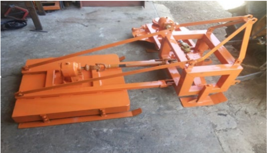
Vista general de prototipo inicial de máquina desmalezadora desde su parte superior, donde se aprecia su cortadora central y lateral. Fuente: proyecto precursor ECOMAGRI - FIA.
