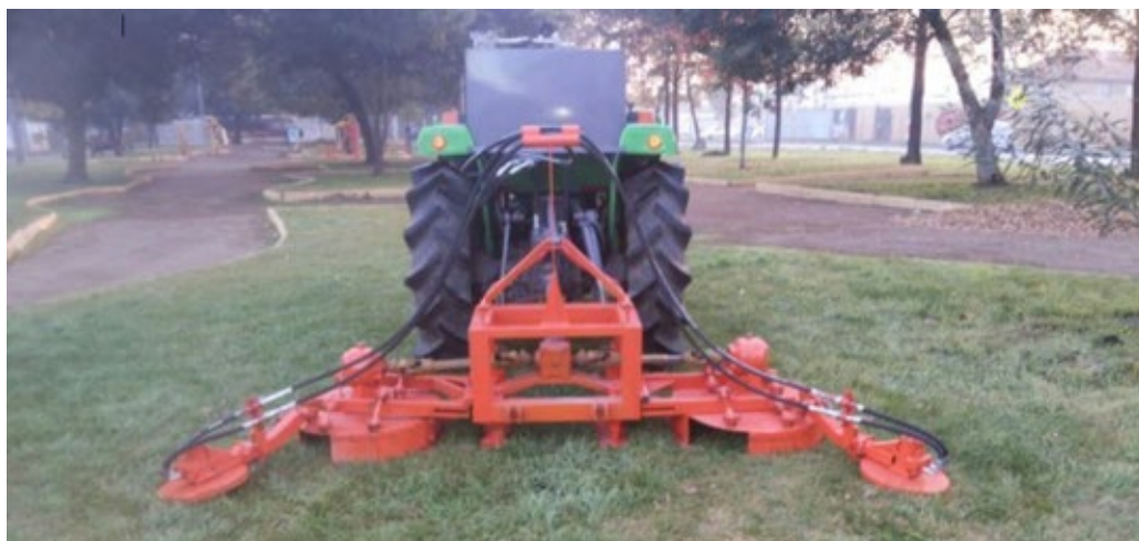
Prototipo final de desmalezadora con incorporación del segundo cuerpo. Fuente: proyecto precursor ECOMAGRI – FIA
