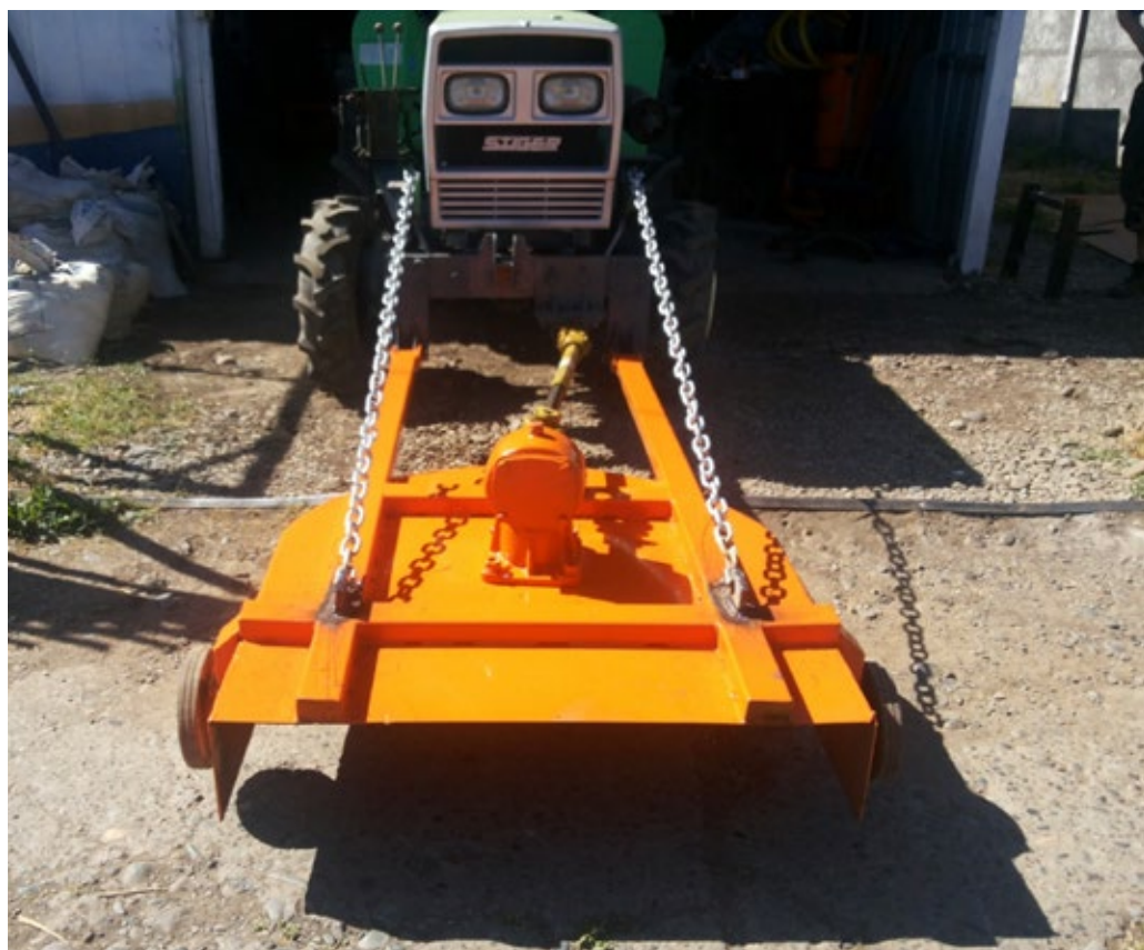
Vista delantera del equipo cortador de machos, suspendido y acoplado al tractor. Primera versión del desarrollo. Fuente: proyecto precursor ECOMAGRI – FIA.
