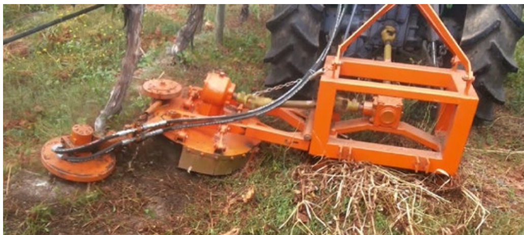
Desmalezadora ejecutando su labor por el camellón y entre parras por medio de sistema hidráulico. Fuente: proyecto precursor ECOMAGRI - FIA.
