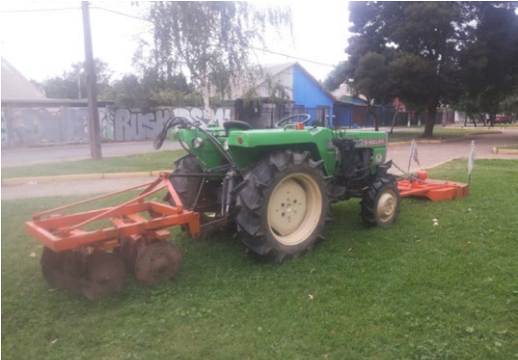
Equipo definitivo de "Maquina cortadora de machos en maíz semillero". Fuente: proyecto precursor ECOMAGRI – FIA.
