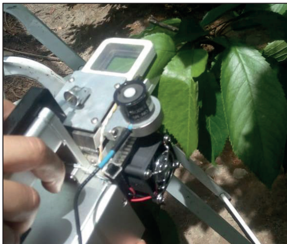
Figura 27. Medición de intercambio gaseoso con medidor de gases infrarrojo que registra la conductancia estomática ( g_s ) y asimilación neta de las hojas ( A_n ).
