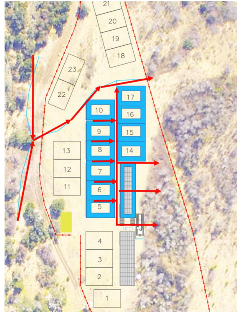
Ilustración 9. Flechas rojas indican drenajes instalados.
