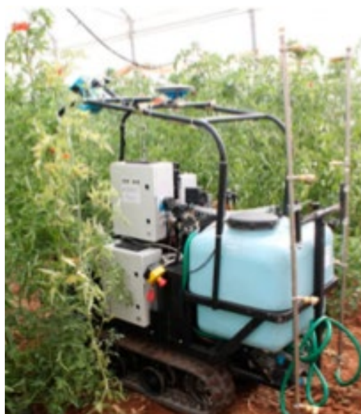
Robot aplicador fitosanitarios. Fuente: AgriEngineering 2019, 1, 391–402
