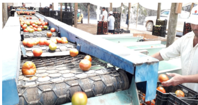
Foto 11. Separación de frutos por diámetro empleando una clasificadora de anillos (Quillota, Chile).
