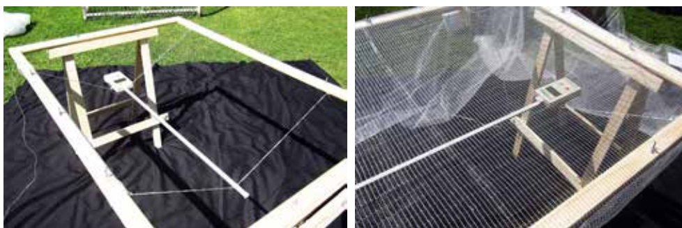
Foto 32. Medición de la transmisión de radiación solar de mallas utilizadas en fruticultura.
