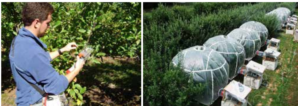
Foto 24. Medición del intercambio de gases de la hoja (izquierda) y del árbol completo (derecha, Gentileza Dr. D.M. Glenn).
