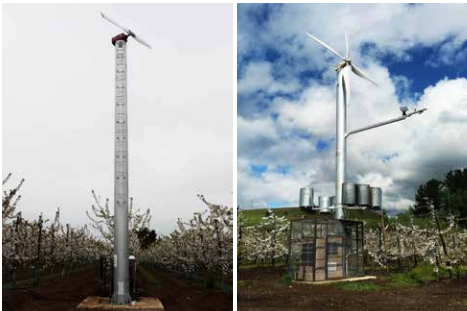
Foto 11. Sistema de control de heladas por movimiento de aire: Torre fija con ventilador (izquierda) y Ventilador con calefactores adosados en sistema combinado de calor y movimiento de aire (derecha).
