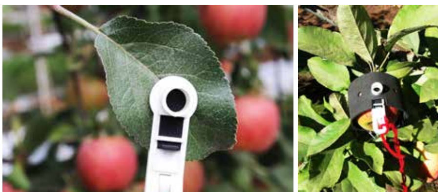
Foto 26. Ambientación de hoja (izquierda) y fruto (derecha), utilizando clips especiales para medición de la eficiencia fotosintética máxima ( F_v/F_m ), a través de la emisión de fluorescencia de la clorofila.
