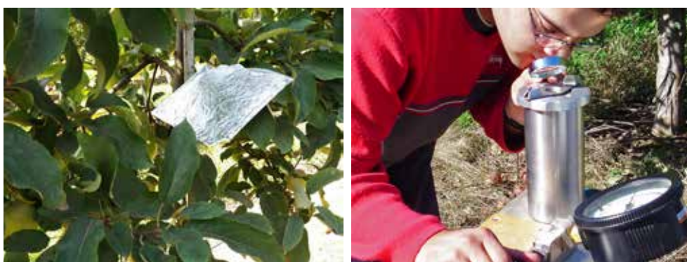
Foto 28. Ambientación de hoja para medición de potencial hídrico xilemático y su lectura con Bomba de Scholander.
