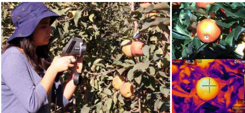
Foto 23. Medición de temperatura del fruto con cámara termográfica.
