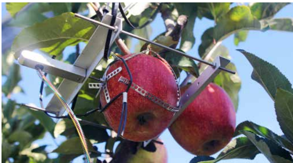
Foto 29. Dendrómetro modificado para medir variaciones diarias en el crecimiento del fruto.
