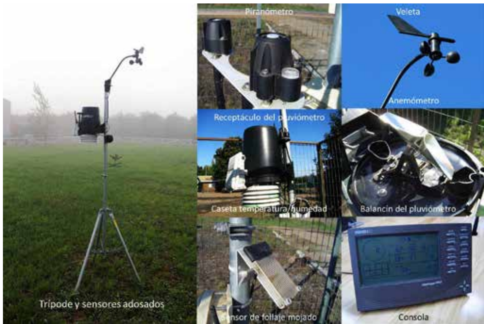
Foto 19. Estación meteorológica automática, partes y sensores.
